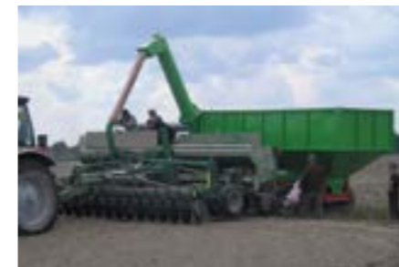
Vetőgép feltöltés flexibilis PVC csővel
