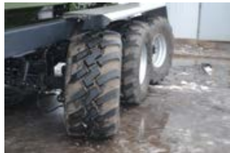
Hidraulikus kormányzású mellső és hátsó tengely
